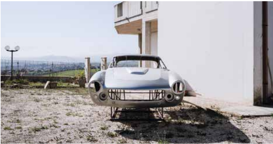
Scocca in alluminio realizzata nel 1968 dalla carrozzeria Mario Allegretti
